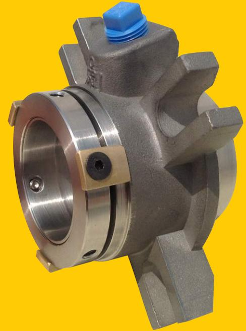
La unidad Sil-6781® es un dispositivo hidráulicamente balanceado que por sus características de diseño y fabricación resulta ser estable en los procesos de alto dinamismo, ya que su empuje de cierre tiene una mejor respuesta, dado que las caras de contacto se encuentran dentro de la brida de fijación haciendo posible una restricción de áreas que ayuda a generar una diferencial de tiempos en los desequilibrios generados por el proceso.
